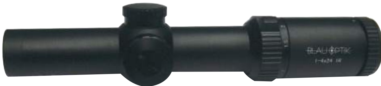
IG36 - CANNOCCHIALE BLAUOPTIK 1-4x24 IR Reticolo inciso Attacchi weaver anello Seethrough Tubo da 30 mm Tappi trasparente e giallo con elastico Torretta 1/4 moa Lunghezza: 242 mm Peso: 420 gr.
